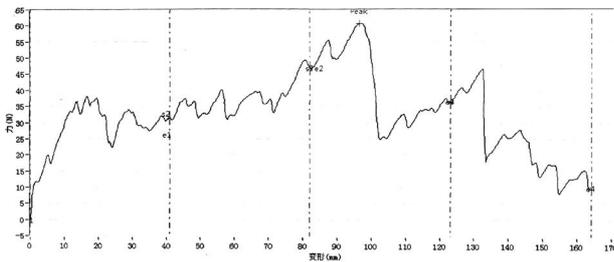
**Résultat du test de résistance de la tige, de la doublure et de l'articulation**
